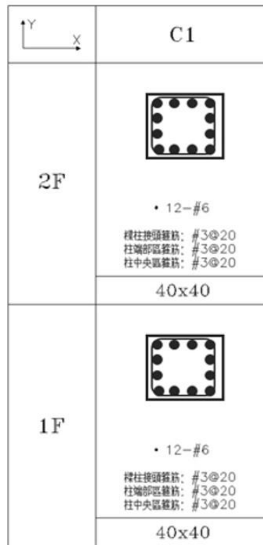
圖 A.3 兩層樓案例之柱斷面圖
