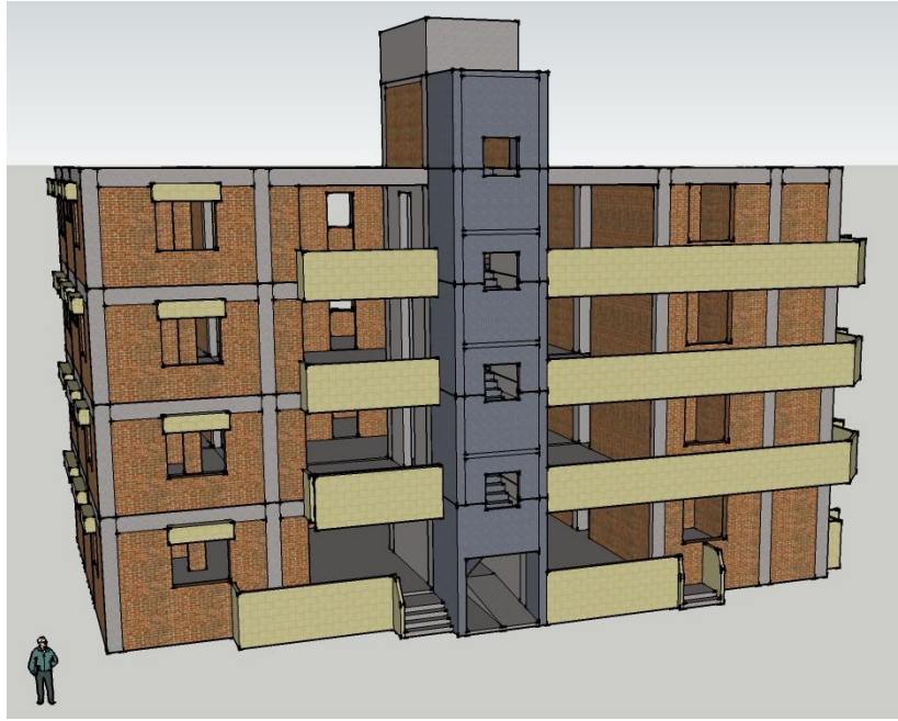
圖 7.62 案例A增設電梯補強建築 3D圖(sketchup模型)
