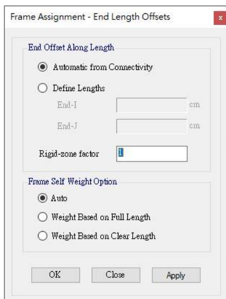
圖C.15 梁、柱剛性區域設定
